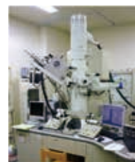
研究室所有の複合電子分光走査透過電子顕微鏡
